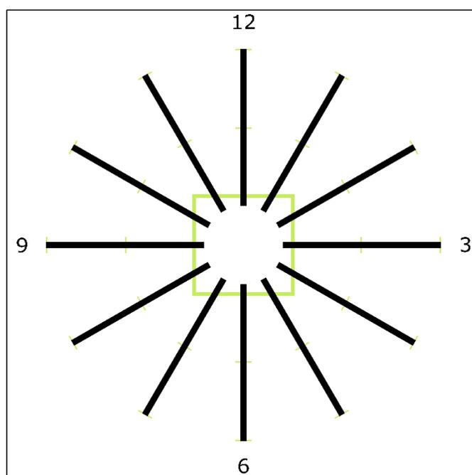
2. В центре поля имеется зона старта квадратной формы, определяющая максимальные габариты робота.
